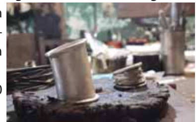
Vom Rohling (Mitte) über die Fertigung (rechts) zum fertigen Ring (ganz links). Copyright: Pakilia
